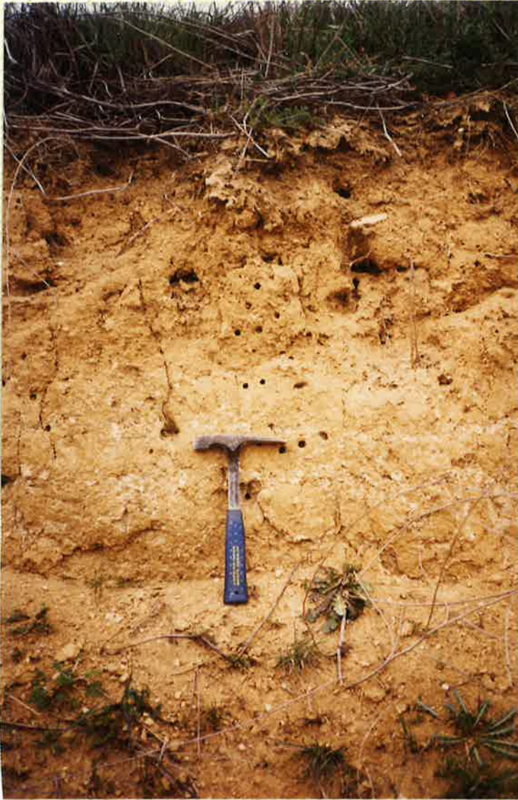
1515-EP-SL-9308. Coluvión de fangos pardos situado justo en el borde del páramo. Presenta un horizonte cálcico con pequeños nódulos (Torrelobatón).
